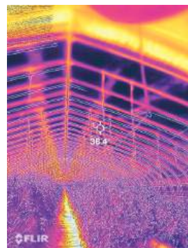
7/25撮影 散布無しハウスフィルム表面温度
