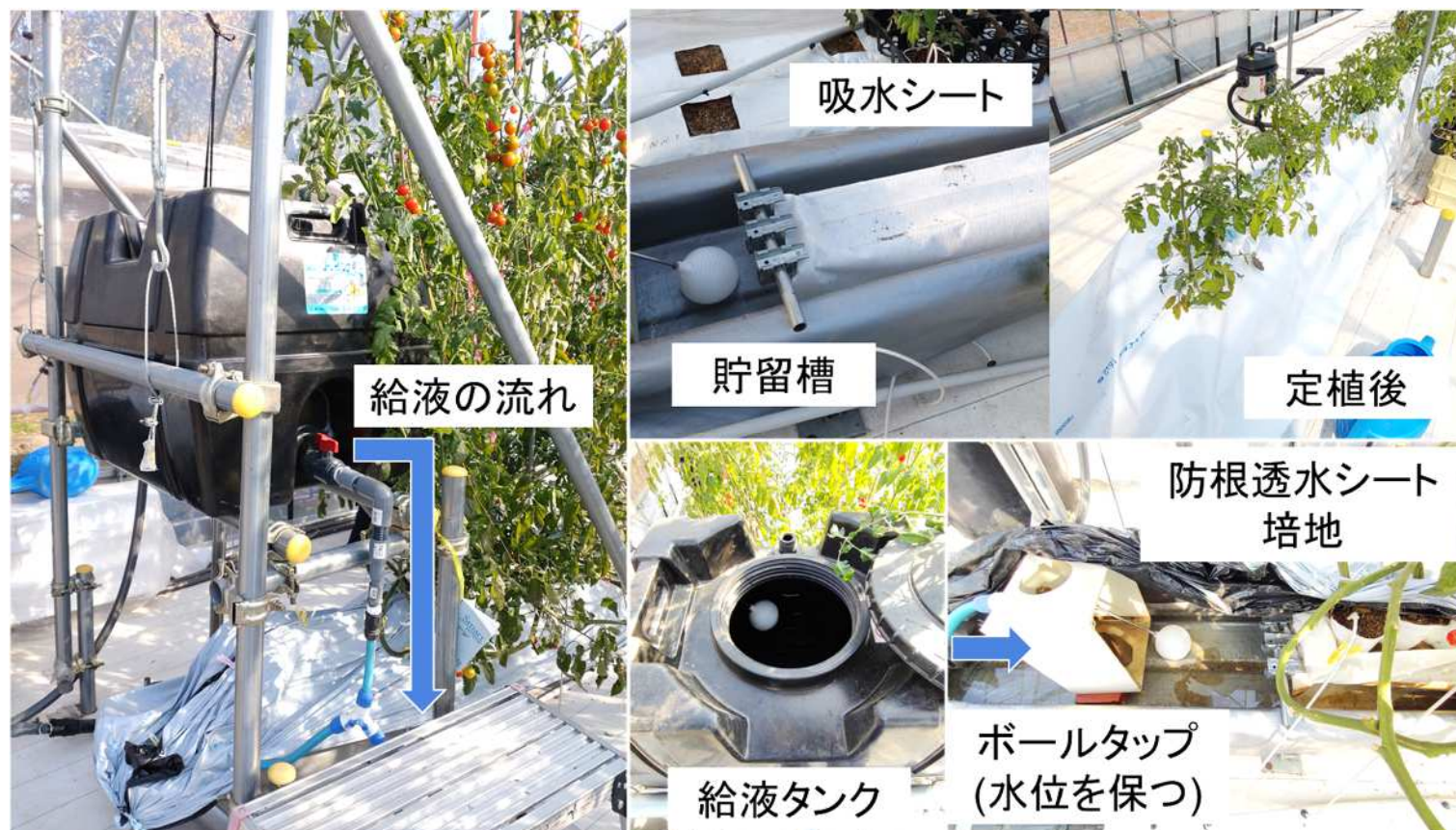
図. NSP栽培装置概要
