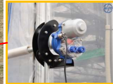
側窓自動開閉
