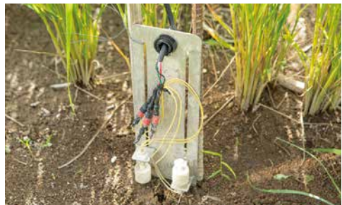
02 水位を測るセンサー。ほ場に設置し、水位の上限と下限を手動で設定します。下限の位置まで水位が下がるとホースが下がり給水を開始、上限まで水位が上がると給水を停止します。
