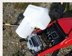
薬剤タンクの交換作業
