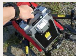
バッテリーの交換作業
